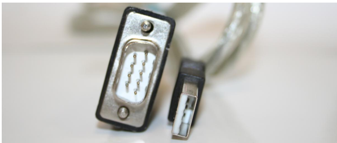
Рис. 9 - Внешний вид кабеля-адаптера COM DB9 (M) -->USB A (M)
